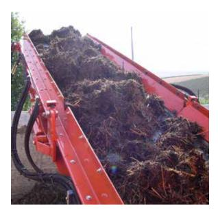
in acciaio ad alta resistenza. Durante la triturazione, i prodotti vengono anche miscelati attivamente, in modo da ottenere un trito omogeneo pronto per il compostaggio.
