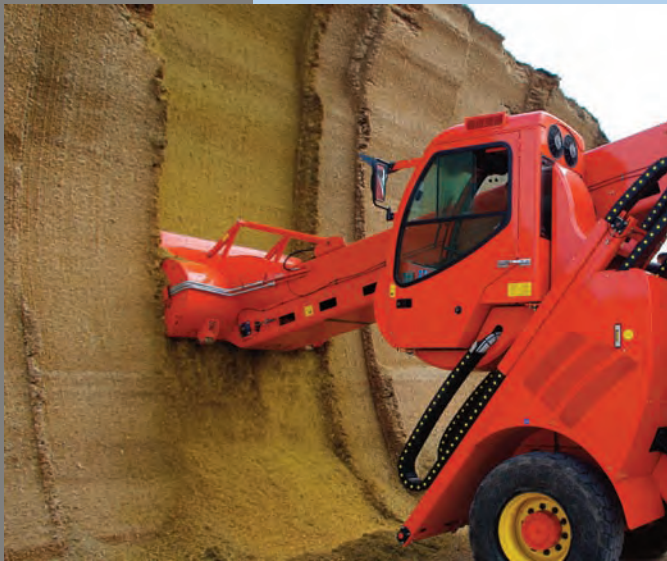
Turbo Refiner Self durante il carico, macinazione e miscelazione dell'insilato
