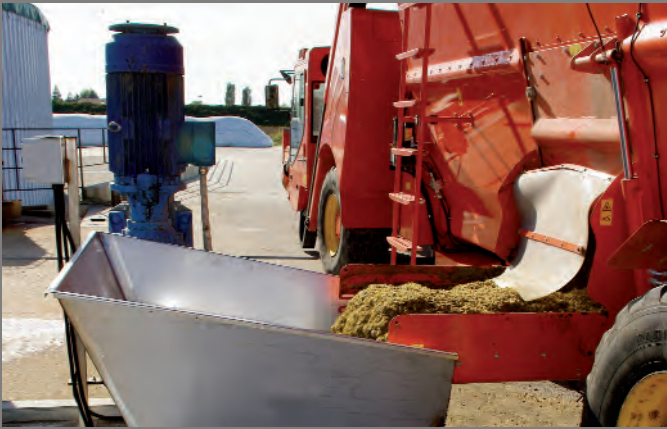
Turbo Refiner Self in fase di scarico della biomassa pretrattata meccanicamente nel prefermentatore "Global Energy"
