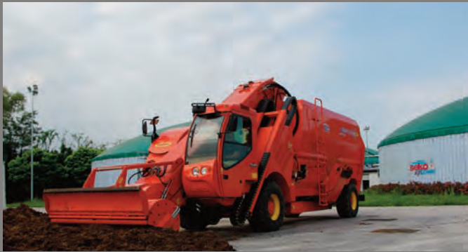
Turbo Refiner Self in fase di carico, macinazione e miscelazione del letame
