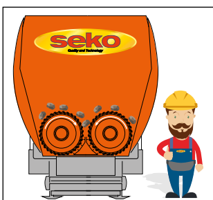
Il sistema SEKO, a basso regime di giri, evita il lancio dei prodotti nell'area di lavorazione
