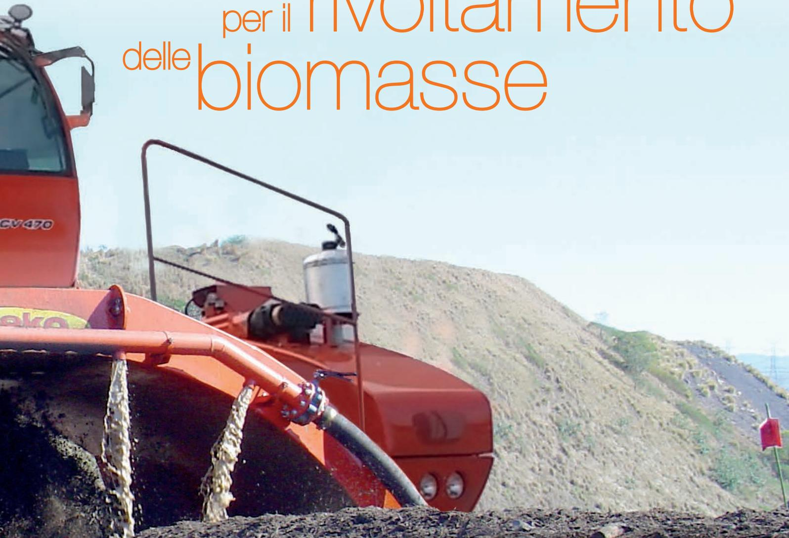
Le rivoltatrici semoventi garantiscono un'efficace ed energetico rivoltamento della biomassa in andana poiché il prodotto in movimento viene smosso mediante un rotore-miscelatore orizzontale o verticale a seconda del modello. Le lame consentono la trinciatura di fibre lunghe e il disgregamento di zolle e blocchi di materiale.
