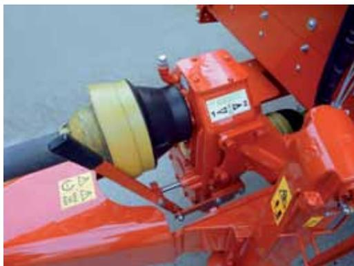
Réducteur épicycloïdale avec couple élevé et boîtier à 2 vitesses pour réduire l'absorption de puissance et accélérer le vidage du produit.
