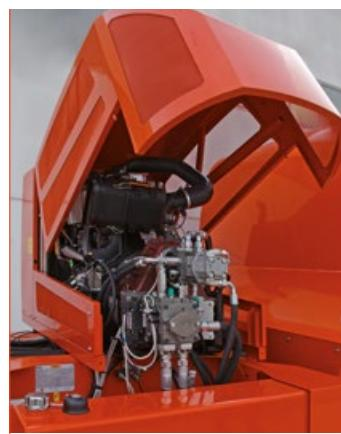
Le moteur diesel Stage 3B avec contrôle électronique intégral offre des performances exceptionnelles avec un meilleur rendement en terme de consommation de carburant. La position frontale du moteur permet un accès facile pour toutes les opérations de contrôle et de maintenance.
