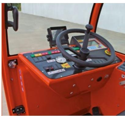
Le système de vue arrière constitué d'un moniteur et 3 caméras couleur assure le confort de conduite et la sécurité de manœuvre même dans des espaces très réduits.
