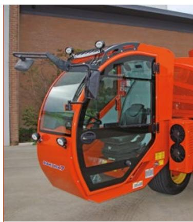
La cabine complet avec système de ventilation et chauffage, siège à suspension et phares de travail, est entièrement vitrée, ergonomique et spacieuse, avec une excellente visibilité qui accroît le confort et la sécurité de l'opérateur.
