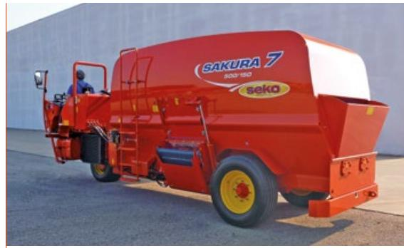
La pelle chargeuse arrière à commande hydraulique, avec une extraordinaire capacité de chargement, permet un chargement autonome de balles et de produits vrac au sol, ce qui simplifie encore votre travail.
