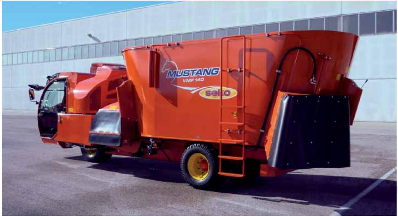
Erhältlich in Volumen von 12, 14 und 16 m<sup>3</sup>, diese selbstfahrenden Maschinen Aufgrund ihrem kleinen Wendekreis sind diese besonders wendig und können auch in Zuchtbetrieben mit geringem Betätigungsraum und engen Durchgängen eingesetzt werden.
