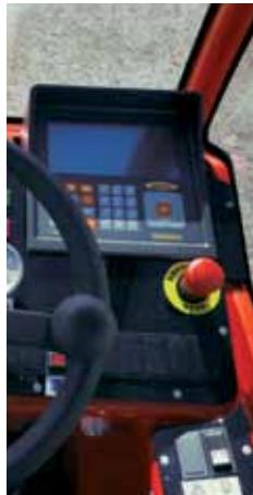
Le poste de pilotage est entièrement intégré avec tous les principaux outils de contrôle tels que le tableau de bord, le moniteur pour les caméras latérales et arrière et système de pesage électronique.
