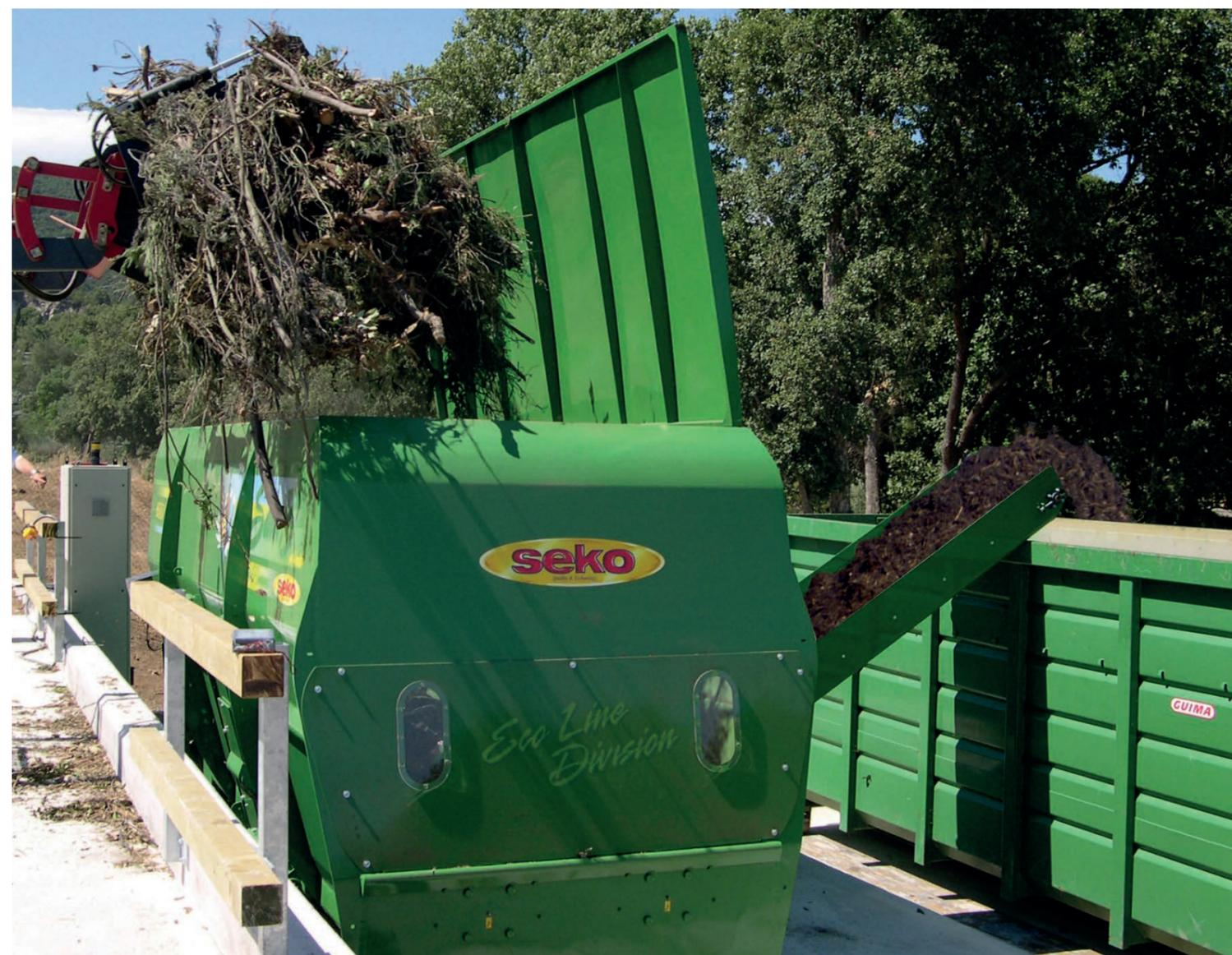
Créés pour apporter une réponse écologique à l'élimination des déchets organiques, les bio-broyeurs SEKO permettent de déchiqeter les débris d'origine végétale qui, correctement hachés, mélangés et aérés avec un apport suffisant en oxygène, se décomposent rapide-
