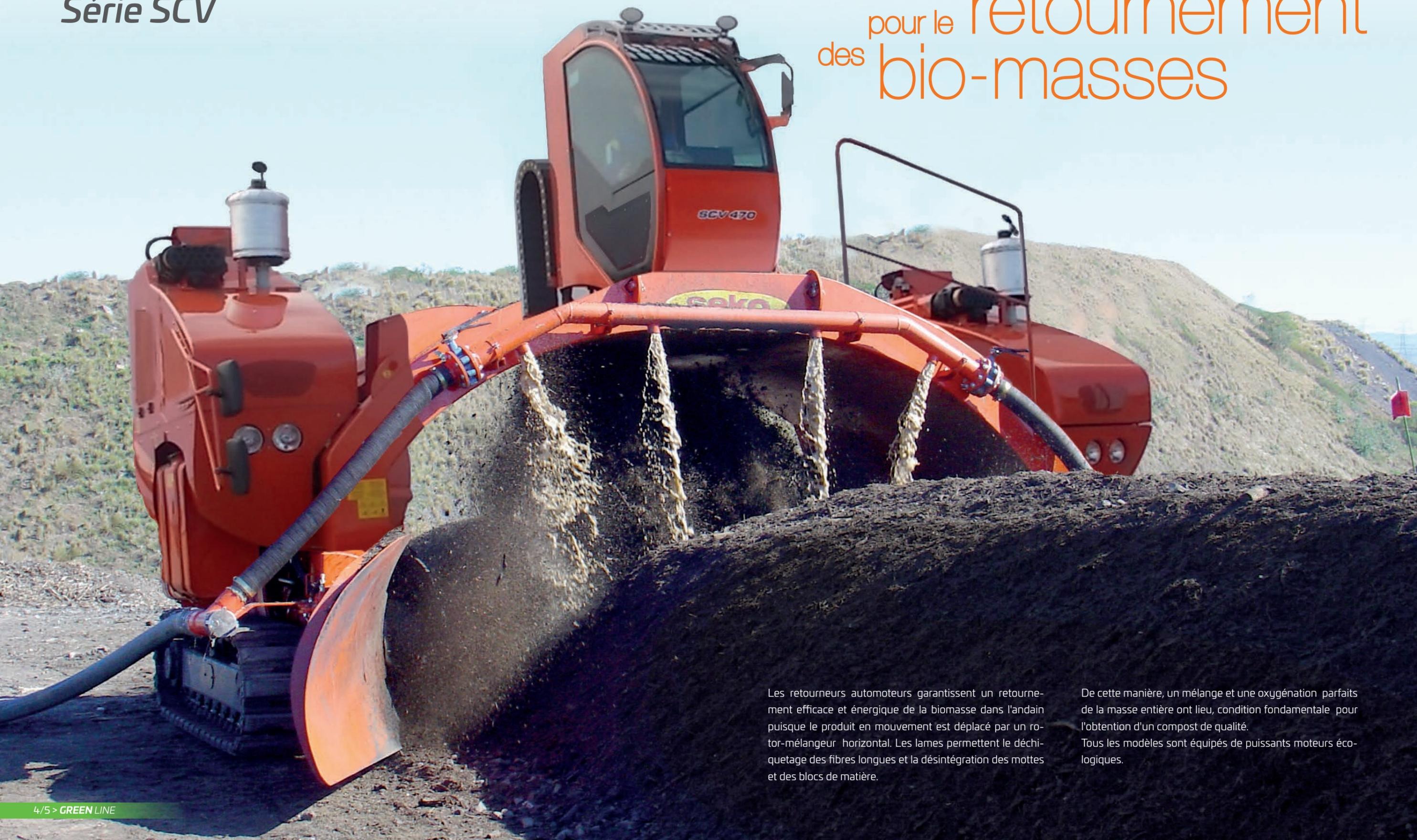
Les retourneurs automoteurs garantissent un retournement efficace et énergétique de la biomasse dans l'andain puisque le produit en mouvement est déplacé par un rotor-mélangeur horizontal. Les lames permettent le déchetage des fibres longues et la désintégration des mottes et des blocs de matière.
