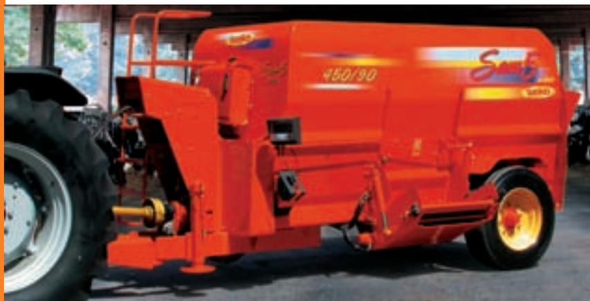
Le timon spécial type "Allemand" homologué TÜV permet une connexion simple et rapide aux tracteurs dotés de crochet de traction placé au dessus de la prise de force, tel qu' on les trouve encore en Allemagne et dans certains Pays de l'Est.
