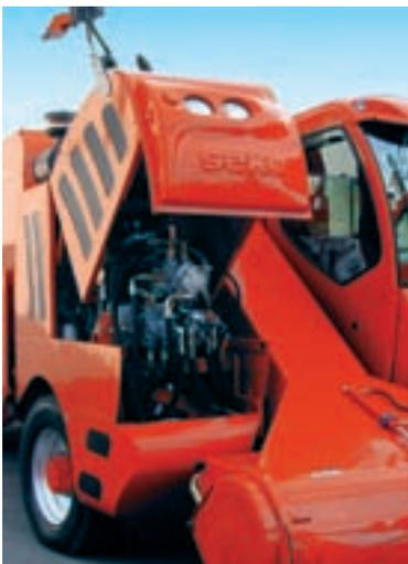
Tous les modèles de la série SAMURAI 5 SELF sont équipés des moteurs puissants, fiables et écologiques Perkins "Stage 2", dotés du système de gestion électronique intégral. Ces propulseurs de 175 CV caractérisés par des niveaux de couple et de puissance élevés, garantissent d'excellentes performances avec le rendement maximum du carburant. Un pot "supersilent" réduit ultérieurement leur déjà bas niveau sonore.
