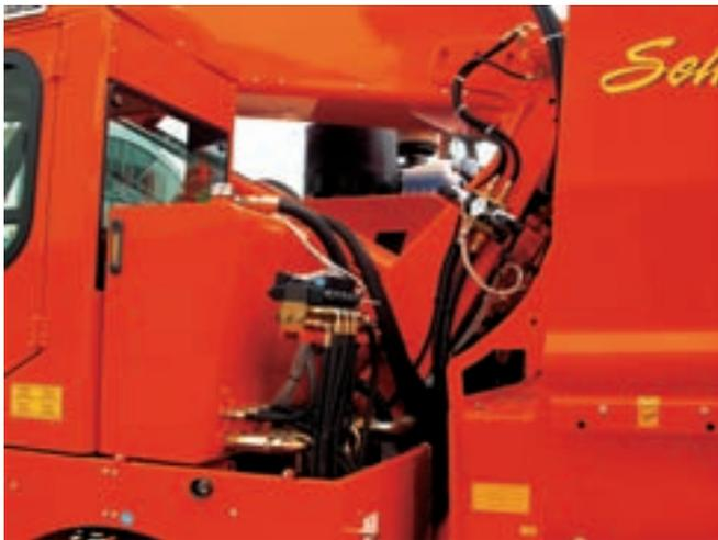
Le système hydraulique est composé de sept pompes : Deux pompes à pistons et trois pompes à engrenages assemblées sur le volant du moteur, plus deux autres bridées sur la prise de mouvement latérale du moteur. Le circuit hydraulique équipé de système by-pass évite toute surchauffe . Il est équipé d'un filtre combiné unique pour un entretien simplifié.
