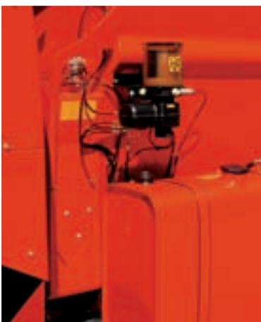
Un nouveau système de graissage automatique, constitué par une pompe au réservoir d'une capacité de 5 litres, assure la lubrification périodique de tous les roulements.
