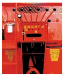
• Console porte-commandes avec commandes à levier "pull-push"
