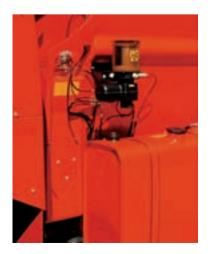
Un nouveau système de graissage automatique, constitué par une pompe au réservoir d'une capacité de 5 litres, assure la lubrification périodique de tous les roulements.
