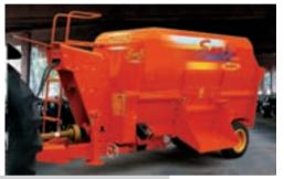
L'échelle d'inspection avec plate-forme d'accès est fournie en standard sur toutes les machines, conformément aux récentes dispositions en matière de sécurité.
