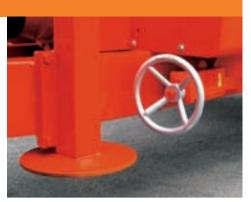
• Frein de stationnement mécanique à volant à main
