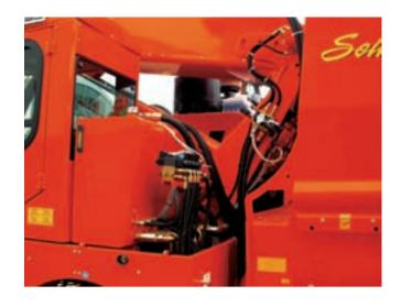
Le système hydraulique est composé de sept pompes : Deux pompes à pistons et trois pompes à engrenages assemblées sur le volant du moteur, plus deux autres bridées sur la prise de mouvement latérale du moteur.
