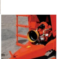
connexion aux tracteurs avec au dessus de la prise de force
